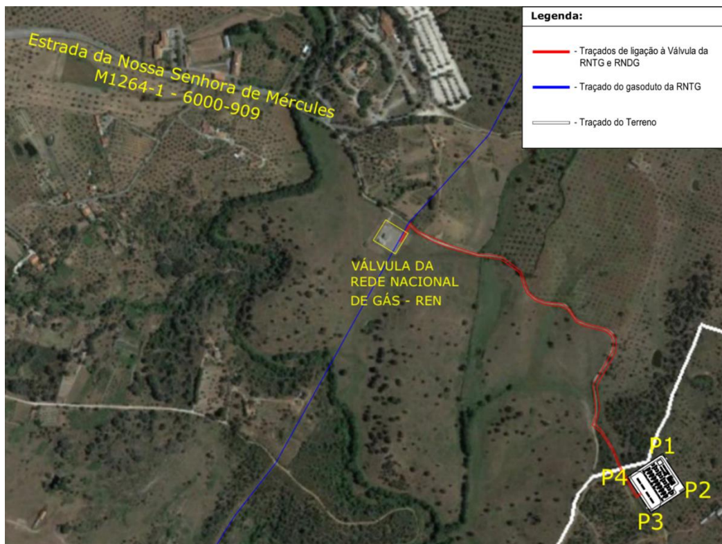
Figura 11 - Traçado da rede de gás da unidade de produção de H 2
